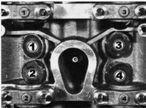
Bevor die Ventile aus dem Zylinderkopf ausgebaut werden, müssen sie markiert werden. Die Markierungen (Zahlen) der Nockenwellenlagerdeckel sind auch in den Zylinderkopf eingeschlagen.
