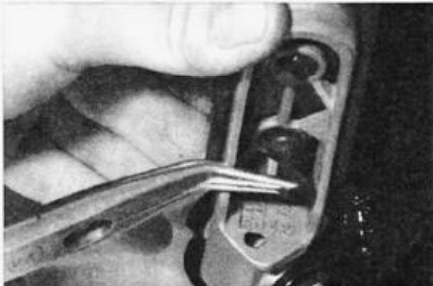
5. Fußrastengummi auf Fußraste legen, mit Zange Gummipippen durchziehen.
