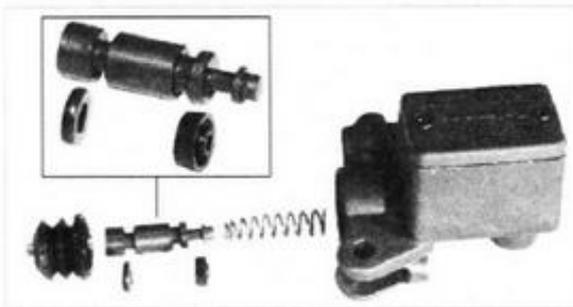
1. Hauptbremszylinder entleeren.
