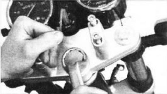
5. Klemmschrauben rechts/links lösen.
