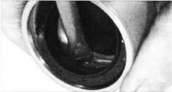
10. Dichtung mit drehender Bewegung der Schraubendreherklinge aus dem Sitz im Gleitrohr herausheben.
