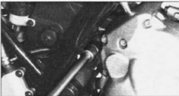
22. Schraube der hinteren Motoraufhängung abschrauben und herausziehen.
