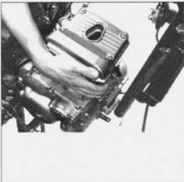
23. Motor im Bereich des Zylinders nach oben schwenken und nach vorn rechts herausnehmen.
