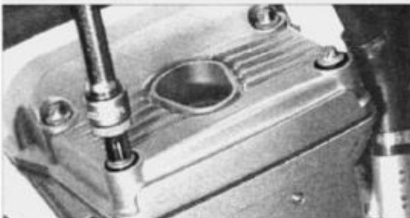
4. 4 Entkopplungselemente aus dem Ventildeckel heraus-schrauben (Torx© E10).
