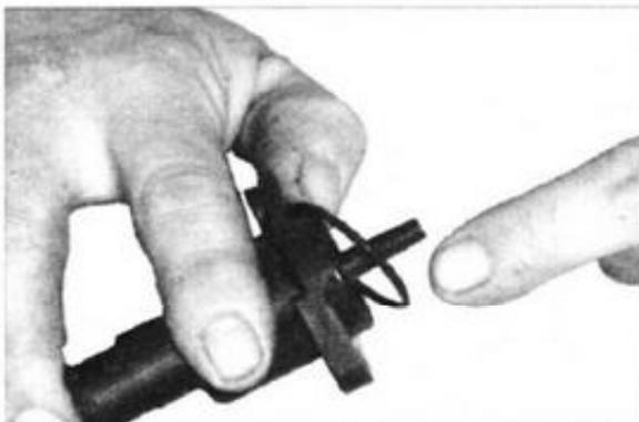
Thermostat und Thermostatgehäuse können nicht voneinander getrennt werden, nur das Oberteil ist demontierbar.
