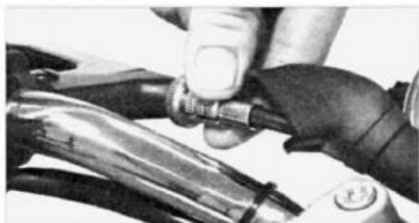
Das Spiel des Seilzugs wird am Kupplungshebel eingestellt. Es wird am Ende des Kupplungshebels gemessen und soll **3 - 5 mm** betragen.
