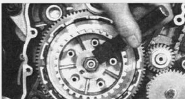
10. Sicherungsblech unter der Mutter aufbiegen.
