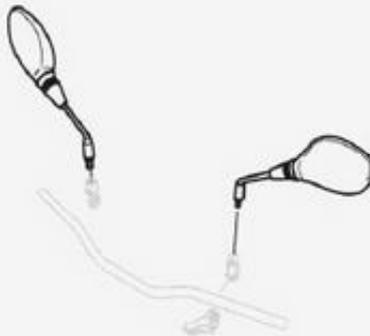
1. Gummihülle hochschieben, Kontermutter (SW 14) lösen.
