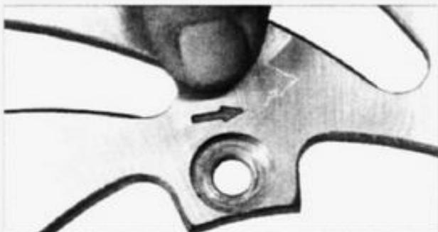
1. Bremsscheibe in Drehrichtung (Pfeil) auf den Adapter legen.
