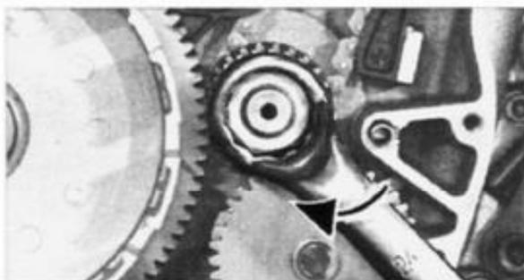
17. Mutter für Pumpenantriebsrad abschrauben. **Linksgewinde!**
