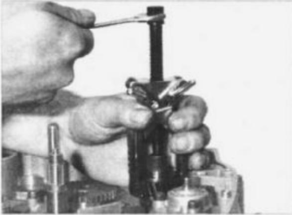
4. Bei Bedarf Mutter M16 (**Linksgewinde!**), Primärtrieb, abschrauben und Antriebszahnrad Pumpen abnehmen.
